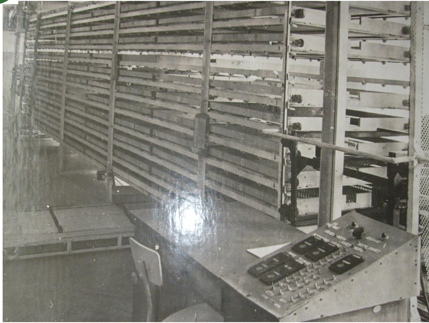
**Механизированная установка для выкормки гусениц тутового шелкопряда
